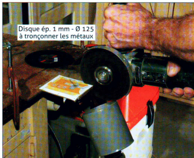
12 Découpe d'ébauche du porte-outil avec un disque à tronçonner.
