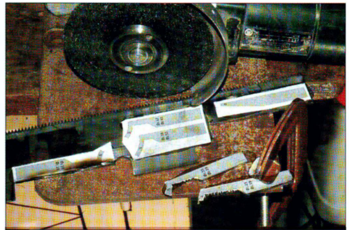
18 Découpage du contour des lames avec la meuleuse d'angle.
