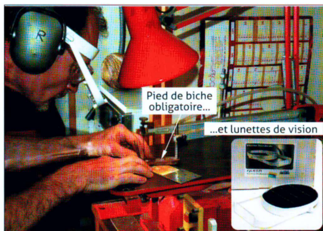
13 Une scie à chantourner est idéale pour les découpes de précision.
